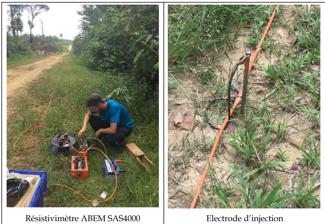
Planche photo 1. Détail du matériel d'acquisition des panneaux électriques.
